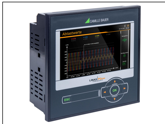
Das PQ3000 ist ein Klasse A-Gerät für den Fronteinbau und ist unabhängig nach IEC 62586-2 zertifiziert. Ein TFT-Bildschirm mit intuitiver Benutzerführung leistet diverse Dienste. PQ-Daten werden mittels PQDIF-Format nach IEEE 1159.3 bereitgestellt, sodass über eine PQ-Auswertesoftware (z. B. SMARTCOLLECT) die Daten analysiert werden können.
