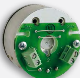
Anschlussprint mit Schraubklemmen
